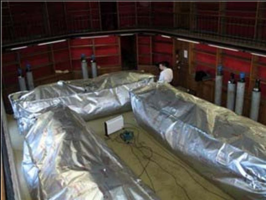
Désinfection par anoxie : livres confinés dans une enceinte étanche, où l'oxygène est remplacé par de l'azote.
